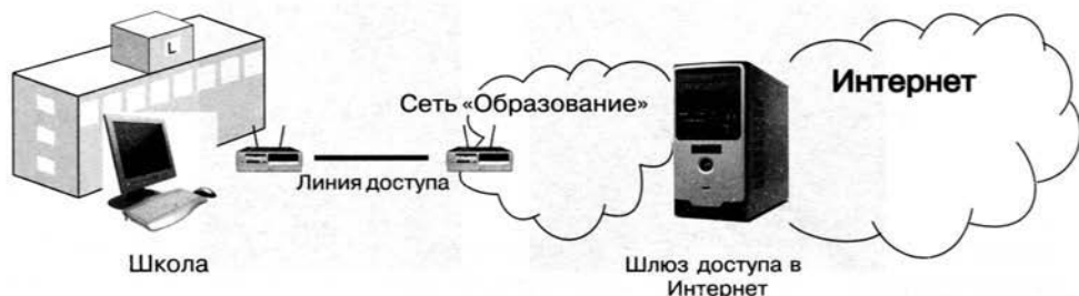
Рис. 4.2. Схема подключения школ к Интернету
